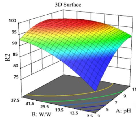
**شکل ۳-** اثر متقابل pH، زمان و نسبت آلاینده به موجود زنده بر حذف سرب با استفاده از فرایند بیولوژیک
